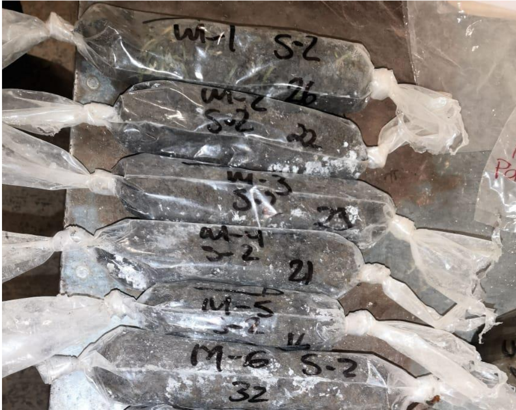
Ilustración 17 Sedimentos recuperados por el Sondeo de penetración en el pozo no.2
