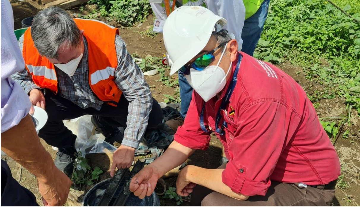
Ilustración 13 Obtención de las muestras de sedimentos mediante Sondeo de Penetración Estándar
